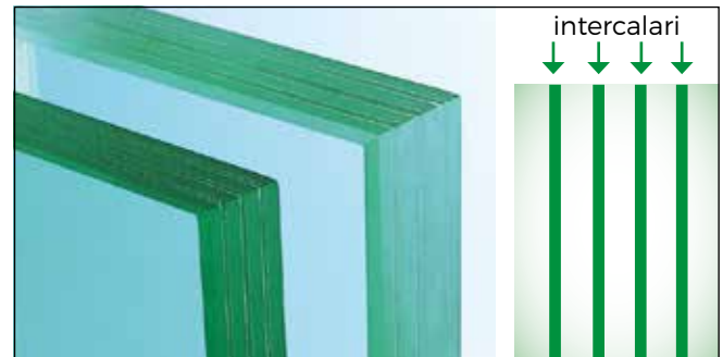
Figura 21 - Il vetro stratificato è un vetro particolare, con funzioni di sicurezza, composto da due o più lastre di vetro assemblate tra loro su tutta la superficie mediante una o più pellicole intercalari. L'intercalare maggiormente utilizzato è il PVB (PoliVinilButirrale). In caso di rottura, l'aderenza tra il vetro e l'intercalare garantisce che i frammenti di vetro non si stacchino dall'insieme (almeno per un periodo di tempo determinato o fino al raggiungimento di uno specifico livello di carico).
