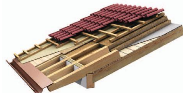
• Particolare della posa della membrana traspirante in gronda.
