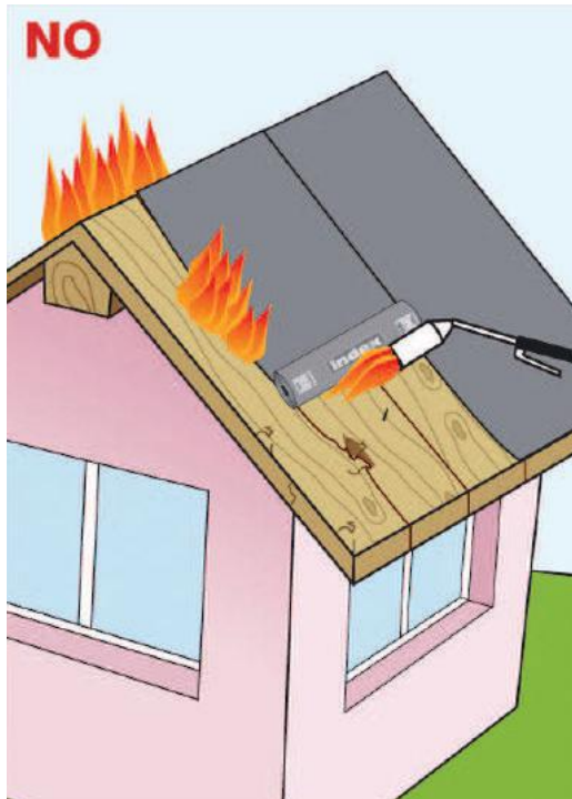
• Posa elementi di tenuta bituminosi autoadesivi.
